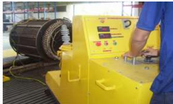
HV AC HIPOT TESTER 24 KV
